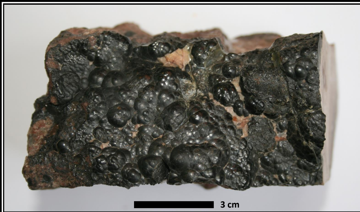
Vzorek uranové rudy. Typický vývin nízkoteplotního hydrotermálního uraninitu ( \text{UO}_2 ) je charakteristický nápadnými ledvinitými agregáty černé barvy s polokovovým leskem. Vzorek pochází z ložiska Petrovice u Nového Města na Moravě a byl zapůjčen ze sbírek Moravského zemského muzea. Fotografie: archiv projektu GeoBarr.
