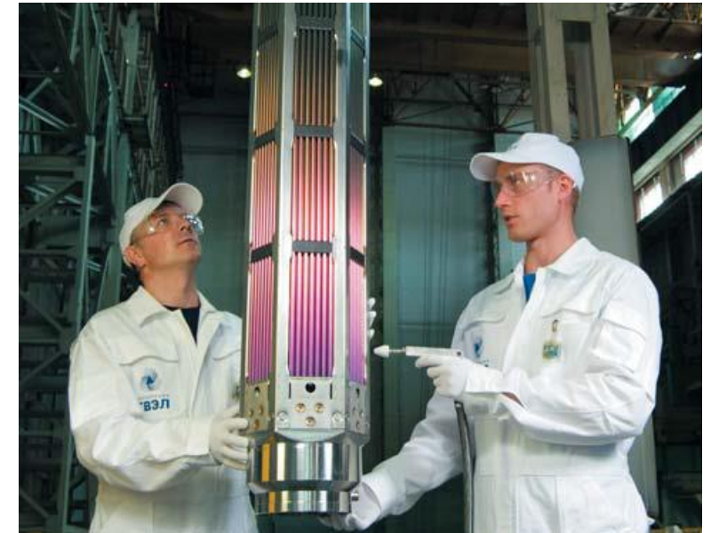
Kazeta čerstvého jaderného paliva společnosti TVEL, používaná v jaderné elektrárně Temelín (Z továrny na výrobu paliva MSZ – Mashinostroitelny zavod)
